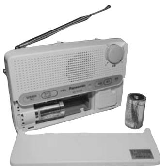
電池交換のフタは正面下側にあります。フタの中心を押しながら下方向にスライドさせて開けます。
